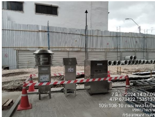
รูปที่ 14 ติดตั้งเครื่องตรวจวัดคุณภาพสิ่งแวดล้อม (คุณภาพอากาศ ระดับเสียง เสียงรบกวน และความสั่นสะเทือนคุณภาพน้ำทิ้ง)
